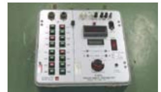
匝比量測設備
